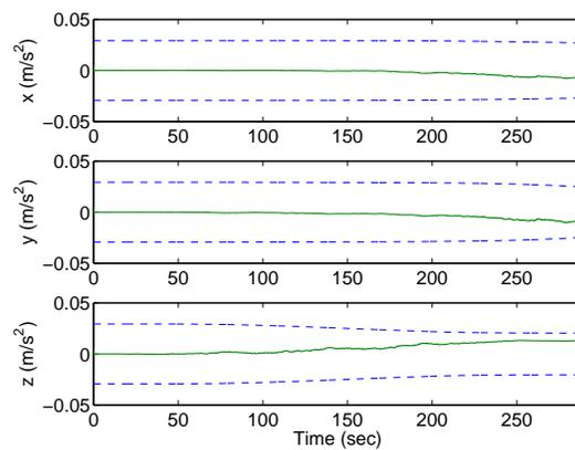
(d) Accelerometer-Bias Errors and  $3\sigma$  Bounds
